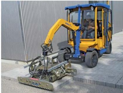
... pour la pose des pavés: innovante, puissante et polyvalente – nouvelle machine de pose VM-401, très confortable.
