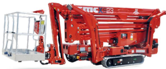
Nacelle araignée articulée avec double pantographe, bras télescopique et jib. La S23 contient 20 ans de succès d'expertise de CMC. Avec des encombrements très compacts (passe à travers une porte normale) c'est le modèle idéale pour travailler dans les espaces internes ou externes. Forte de sa solidité sans pareil et aux différents zones de stabilisation elle devient la nacelle parfaite pour n'importe qu'application.
