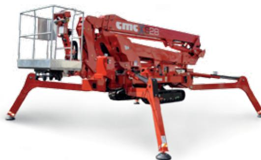
Nacelle araignée avec deux bras télescopiques articulés plus jib. Un concentré de puissance et technologie. Avec quatre zone des stabilisation, deux zones de travail et stabilisateur qui peuvent passer au-dessus rendre la nacelle capable de travailler sur chaque terrain et de rejoindre des points les plus difficiles. Vingt-huit mètre d'hauteur de travail maximale, 14 mt de déport latérale maximale et 6,7 m de travail en négatif fait-elle une nacelle sans pareil.
