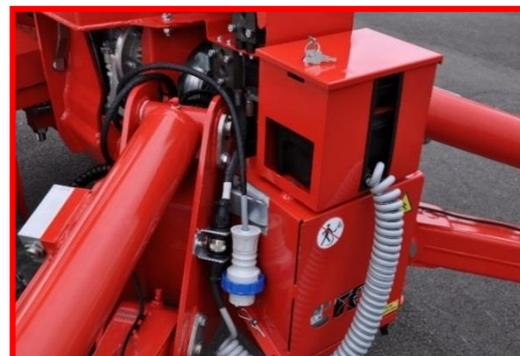
Figure 8 : branchement de la télécommande filaire.
