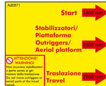
Figure 44 : indication pour le levier d'accélérateur Yanmar\*.
