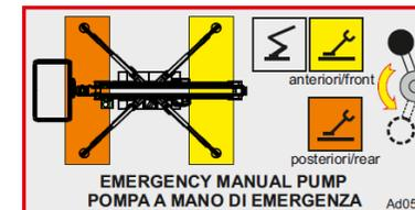
Figure 60 : robinet pour échange d'alimentation plateforme/stabilisateurs en cas d'utilisation de la pompe manuelle.
