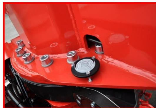
**Figure 15 : niveau à bulle sur châssis.**
