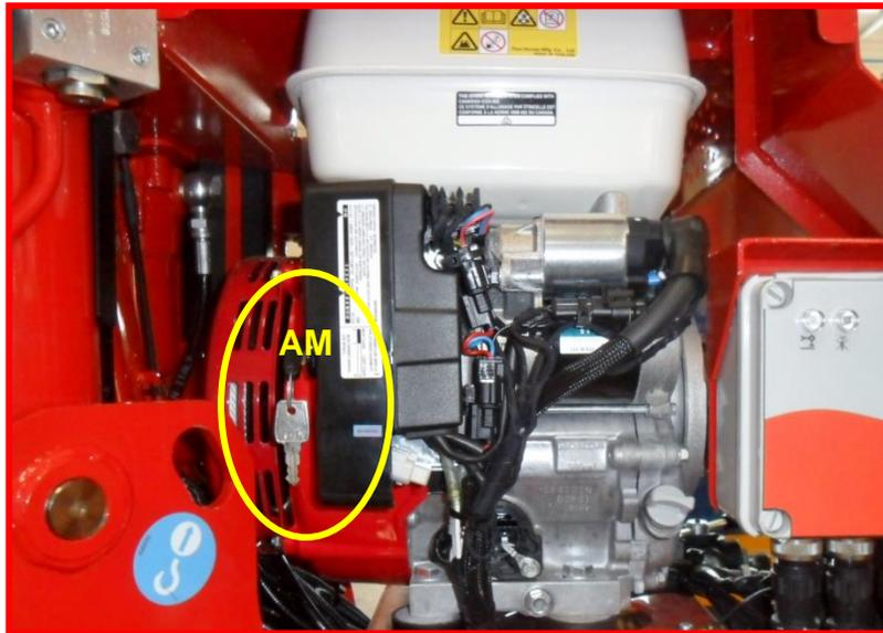
Figure 4a : emplacement de clé pour allumage/arrêt moteurs.
