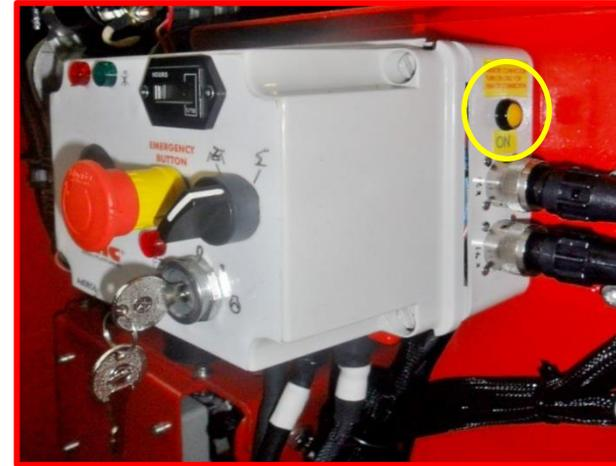
**Figure 77 : interrupteur de connexion à distance sur le boîtier du châssis.**
