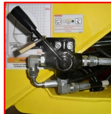
Figure 6 : sélecteur des commandes plateforme.
