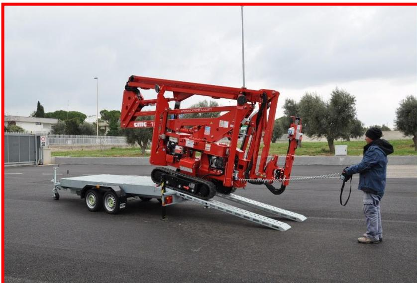
Figure 13 : chargement / déchargement à l'aide d'une rampe.
