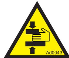
Figure 72 : danger d'écrasement et de cisaillement.
