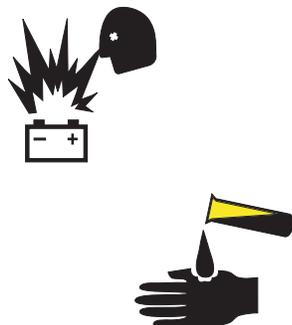
Les batteries contiennent de l'acide. Toujours porter des vêtements et des lunettes de protection pour travailler sur les batteries.
