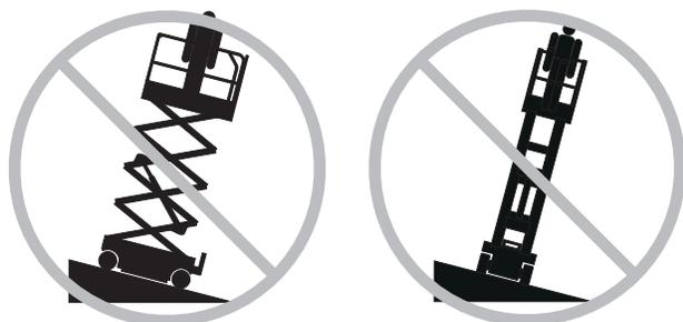
Ne pas se fier à l'alarme de dévers pour indiquer le niveau. L'alarme de dévers retentit sur le châssis uniquement lorsque la machine se trouve sur une pente.
