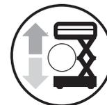
Lorsque la nacelle descend, elle doit s'arrêter à 2,1 m environ du sol. S'assurer que la zone située sous la nacelle est dégagée et sans obstacles avant de poursuivre la manœuvre. Pour continuer la descente de la nacelle, relâcher la manette de contrôle et l'actionner à nouveau au bout de 5 secondes.
