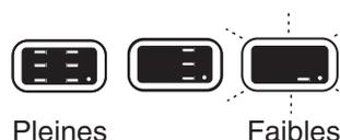
Utiliser la DEL de diagnostic pour déterminer le niveau des batteries.
