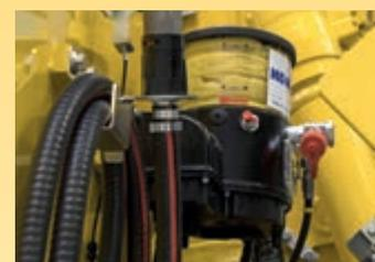
Graissage centralisé automatique (en option)
