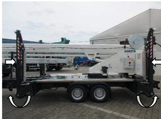
Fig.44 : Contrôler les étais
