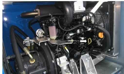
Fig.82 : Jauge d'huile moteur diesel
