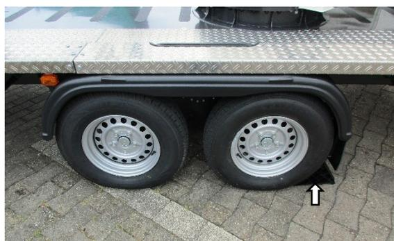
Fig.70 : Poussez le sabot d'arrêt en-dessous.
