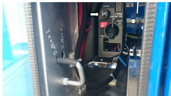
Fig.97 : Poussez le levier de démarrage à froid dans sa position initiale
