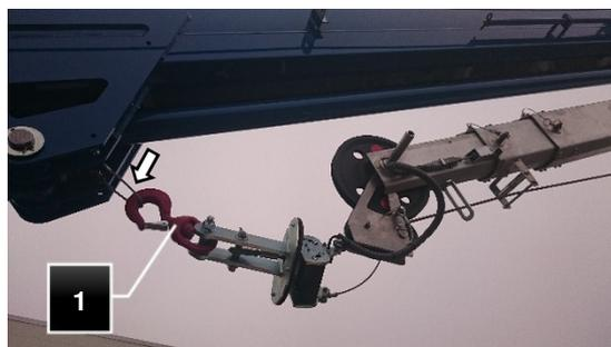
Fig.118 : Ôter le crochet porte-charge
