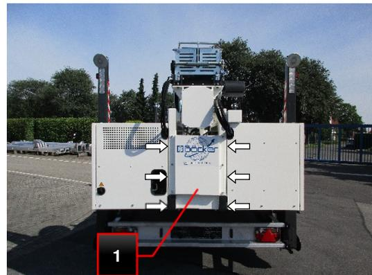
Fig.210 : Couvercle des valves de commande
