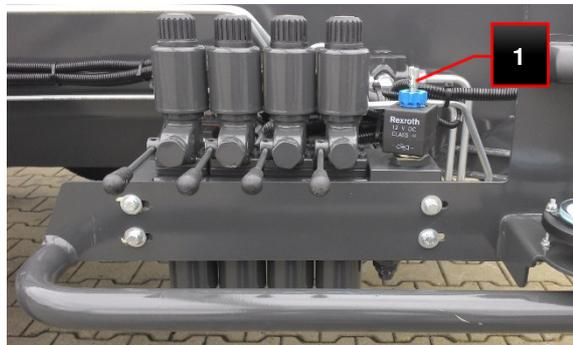
Fig.202 : Désactiver le bloc de commande châssis
