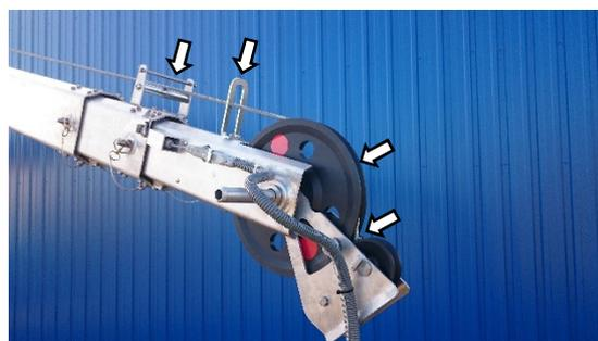
Fig.161 : Contrôler la position du câble
