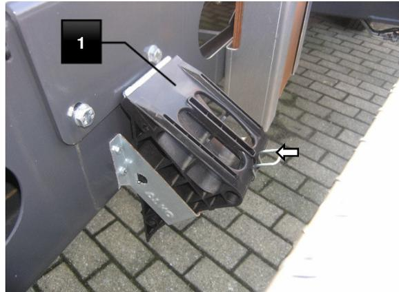
Fig.65 : Insérer le sabot d'arrêt
