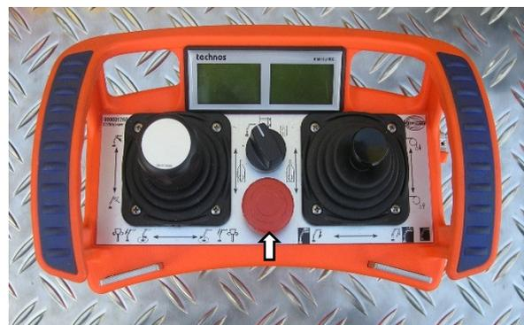
Fig.89 : Interrupteur ARRÊT D'URGENCE
