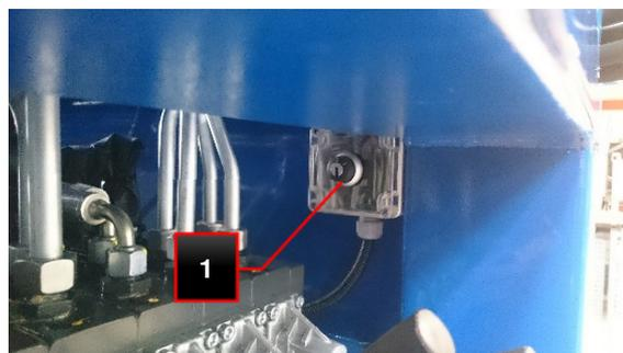
Fig.213 : Interrupteur à clé
