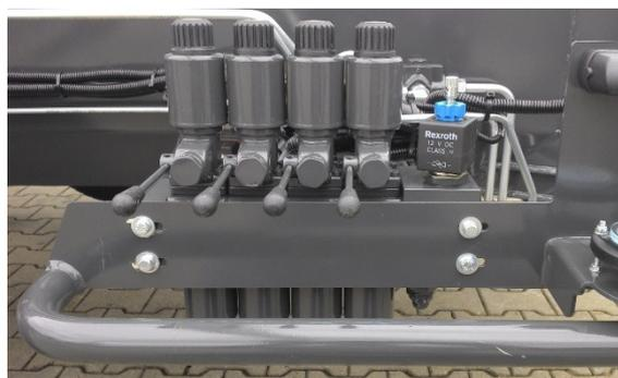
Fig.198 : Bloc de commande châssis
