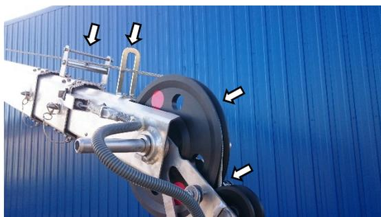
Fig.130 : Contrôler la position du câble
