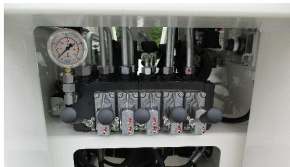
Fig.194 : Commande des vannes
