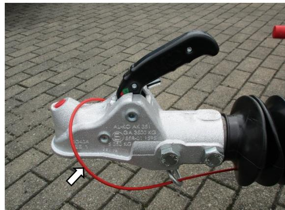
Fig.53 : Câble de rupture d'attelage du frein d'inertie
