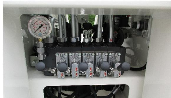
Fig.214 : Commande des vannes
