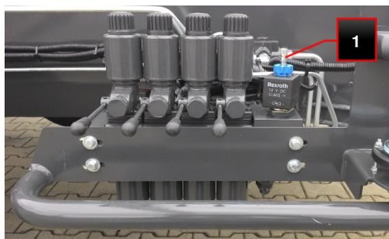
Fig.196 : Bloc de commande châssis
