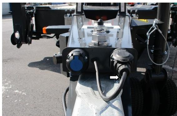
Fig.71 : Retirez le câble de connexion
