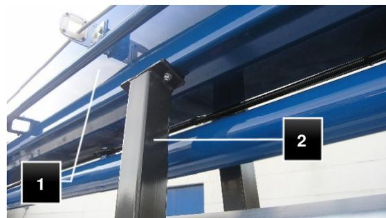
Fig.164 : Contrôler la position du mât télescopique
