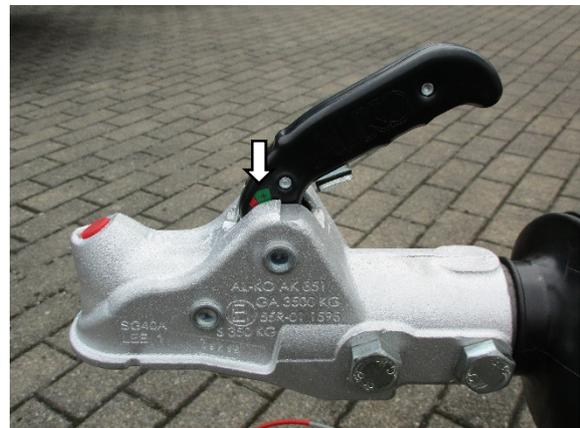
Fig.52 : Indicateur d'usure
