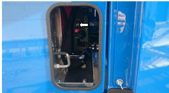
Fig.93 : Tirez le levier de démarrage à froid
