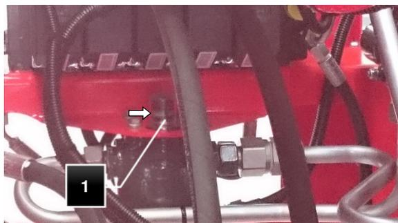
Fig.179 : Contrôlez visuellement le filtre d'encrassage
