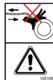
Fig.5 : Ne mettez jamais la main dans le treuil à câble
