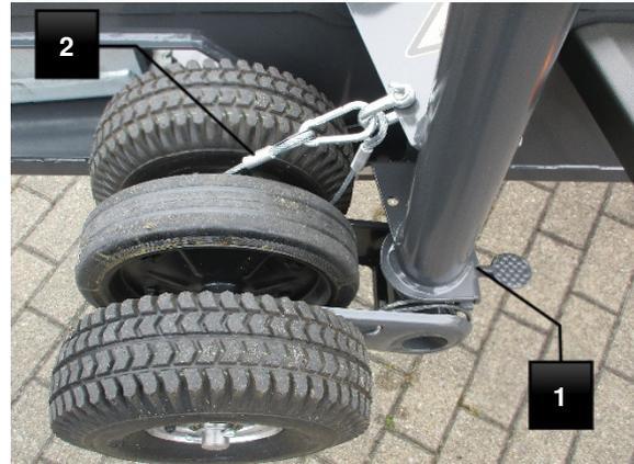
Fig.56 : Sécuriser la roue d'appui
