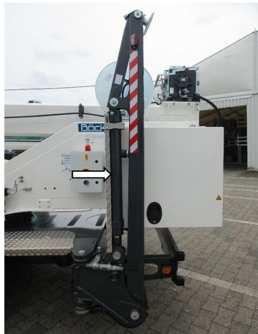
Fig.43 : Contrôler les étais
