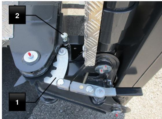
Fig.45 : Contrôler les étais
