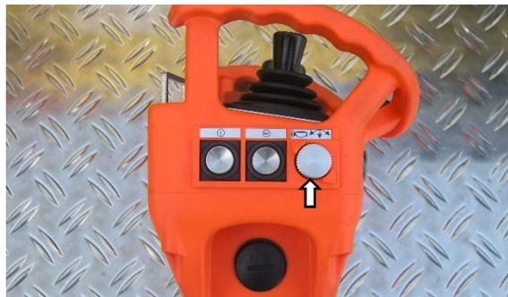
Fig.96 : Démarrage du moteur
