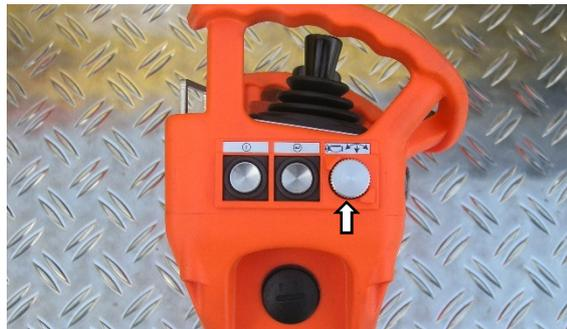
Fig.94 : Démarrage du moteur
