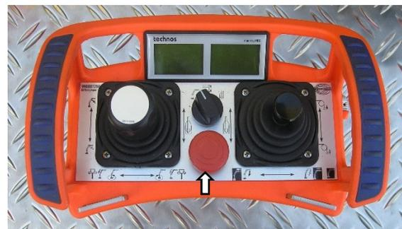
Fig.95 : Démarrage du moteur
