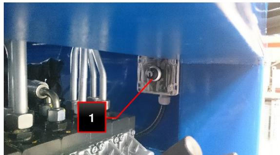
Fig.193 : Interrupteur à clé
