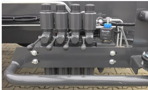
Fig.218 : Bloc de commande châssis
