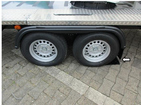
Fig.157 : Poussez le sabot d'arrêt en-dessous.
