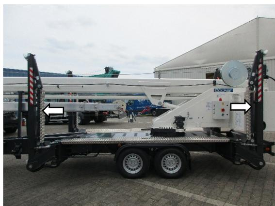
Fig.173 : Contrôler les cylindres de support
