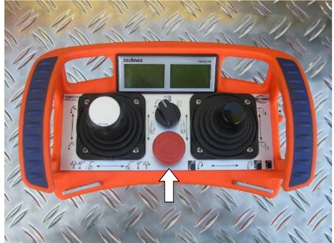
Fig.28 : Interrupteur d'arrêt d'urgence
