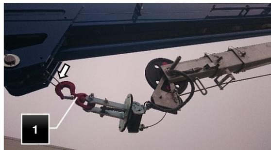
Fig.163 : Accrocher le crochet porte-charge
