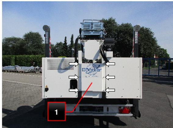
Fig.189 : Couverture des valves de commande
