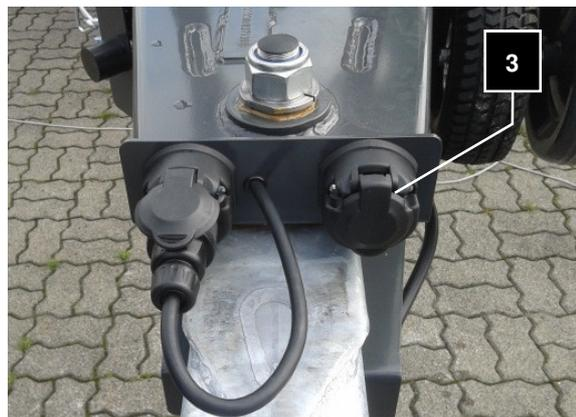
Fig.58 : Brancher le câble de connexion
