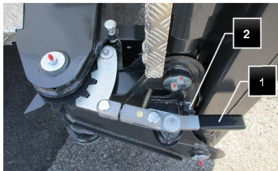
Fig.105 : Contrôler le levier de verrouillage
