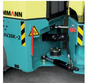
Articulation oscillante revêtue de téflon, graissée à vie
