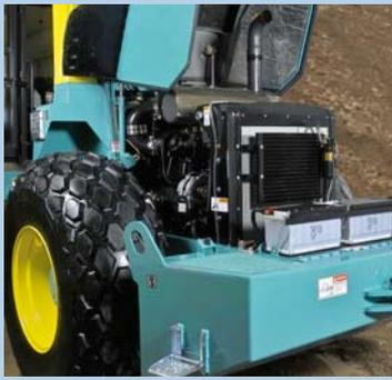
Implantation du moteur et de la batterie accessible
