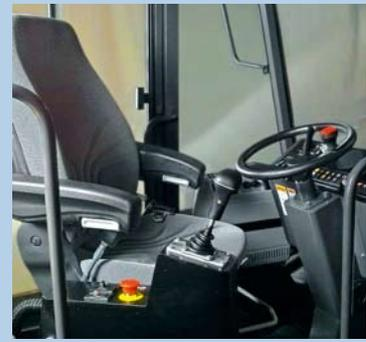
Cabine intégrée avec un siège rotatif
