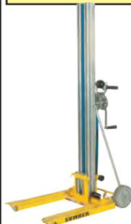
Le leve-matériaux à deux mâts 2210, qui a la plus haute portée de tous les leve-matériaux de la série 2200, permet de soulever des appareils d'éclairage ou des appareils de conditionnement d'air dans les bâtiments dont le plafond est bas. Ses fourches sont adaptées à la largeur de la plupart des dalles de plafonds acoustiques.
