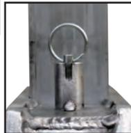
Goupilles d'arrêt verrouillant les pieds de la charpente en A
