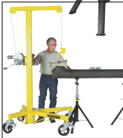
Positionnez les accessoires de tuyauterie avec l'Adjust-A-Fit de Sumner
