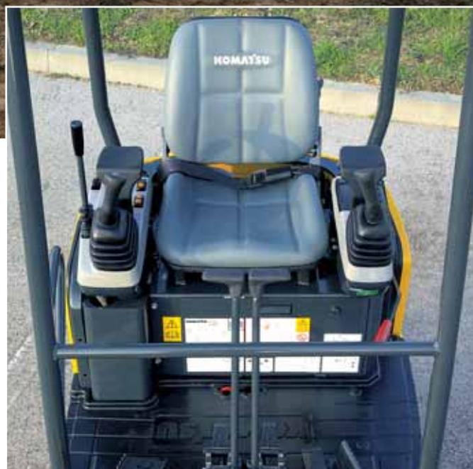
Le bouton d'interrupteur de vitesse se trouve sur le panneau où l'opérateur peut contrôler en permanence toutes les fonctions de la machine.
