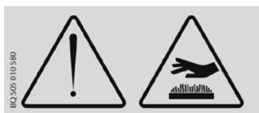
9. L'autocollant apposé sur le carter de protection des courroies trapézoïdales proche de l'échappement du moteur indique un risque de brûlure dans cette zone.
