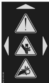
10. L'autocollant apposé sur le carter du mécanisme supportant l'ameneur qui coulisse verticalement, avertit des risques de pincement/écrasement. Eloigner toutes parties sensibles. Cet autocollant indique aussi sur le carter du mécanisme de l'ameneur qu'une chaîne est cachée dessous. Une fois ôté, il y a un risque d'entraînement pour les parties sensibles. Il est formellement interdit d'utiliser la machine sans carter de sécurité.
