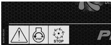
7. Cet autocollant, collé sur la chambre de broyage, avertit l'utilisateur du danger de coupures par les lames lors de l'ouverture de la trappe d'entretien donnant accès aux lames. Il est obligatoire d'éteindre le moteur thermique et de s'assurer de l'arrêt complet du rotor. Faut attendre minimum 1 minute pour s'assurer de l'arrêt complet des pièces tournantes avant l'intervention.
