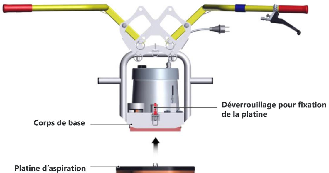
La platine d'aspiration doit être fixée au corps de base à l'aide des deux attaches rapides présentes.
