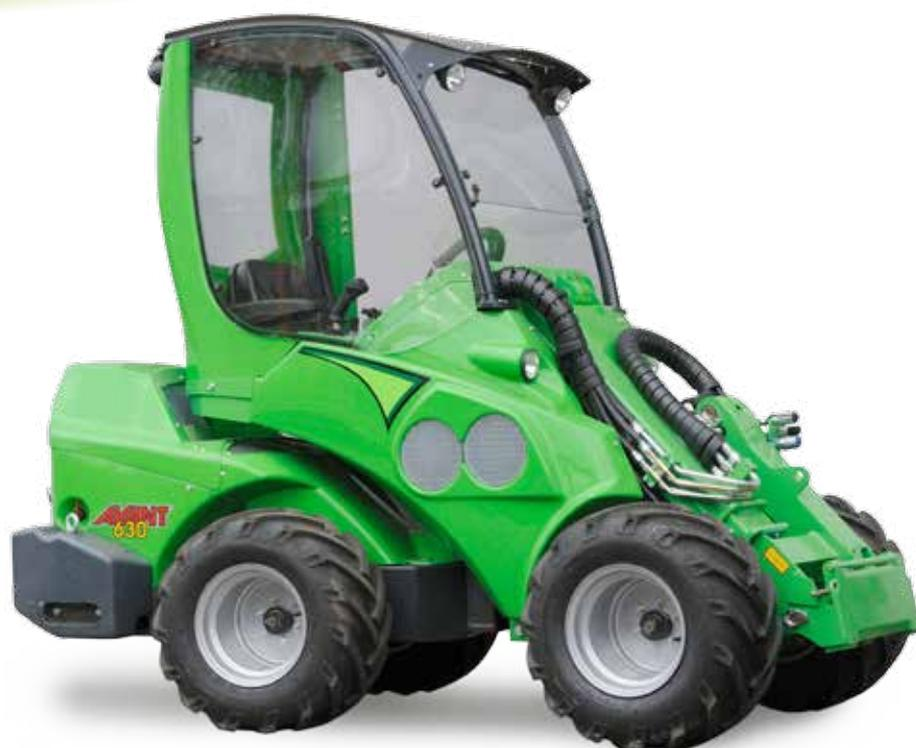
L'AVANT série 700 est équipée en standard d'un arceau de sécurité ROPS/FOPS avec toit plexi teinté. De plus, il y a trois cabines différentes disponibles en option:
