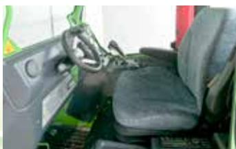
Siège à suspension pneumatique
